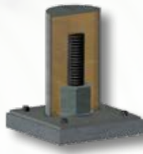
Tapa de acero con soldadura y conexión con pernos
